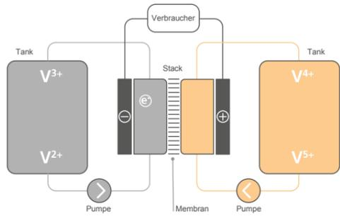
Der STORAC hat mit Vanadium-Katholyt und -Anolyt gefüllte Elektrolyt-Tanks, die Energie in Form von gelösten Vanadium-Ionen speichern. Zur Bereitstellung von elektrischem Strom wird das Elektrolyt aus den Tanks durch den Stack gepumpt, wo die Umwandlung der elektrischen Energie in unterschiedliche Oxidationsstufen des Vanadiums erfolgt. Die Membran im Stack erlaubt den Ionenaustausch: Elektronen fließen dabei über den Verbraucher und können als elektrischer Strom genutzt werden.
